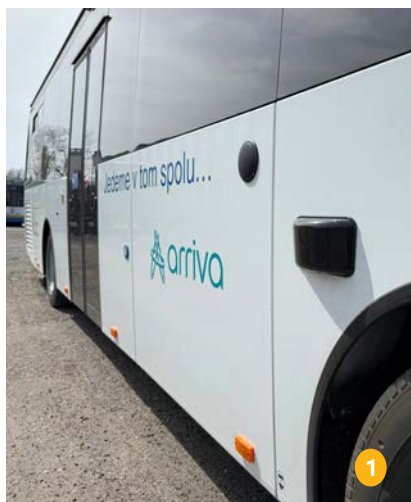
Obr. 1 – Na snímku je dobře patrná „nová bradavice“, která po faceliftu přibyla na bočníci na vozidlech vybavených systémem ADAS. Jde o dvojici sdružených bočních radarů SRR. Tyto radary snímají prostor v úhlu 40° před i za vozidlem a monitorují oblast vedle vozidla, včetně bočních překážek a cyklistů pohybujících se v mrtvém úhlu.
