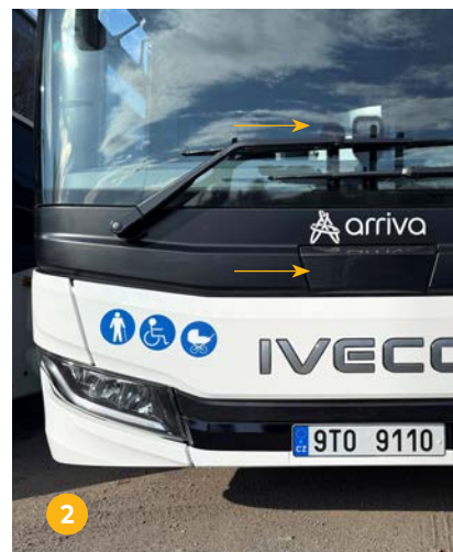
Obr. 2 – Horní šipka směřuje na kameru SCAM4T, která se skládá ze dvou čoček (střední zorné pole a rybí oko). Tuto kameru využívají systémy AEBS , asistent únavy řidiče, ISA , MOIS a systémy hlídající vyjetí z jízdního pruhu. Spodní šipka ukazuje na radar středního dosahu MRR a radar krátkého dosahu SRR. Tyto radary jsou klíčové pro systémy AEBS a adaptivní tempomat.
